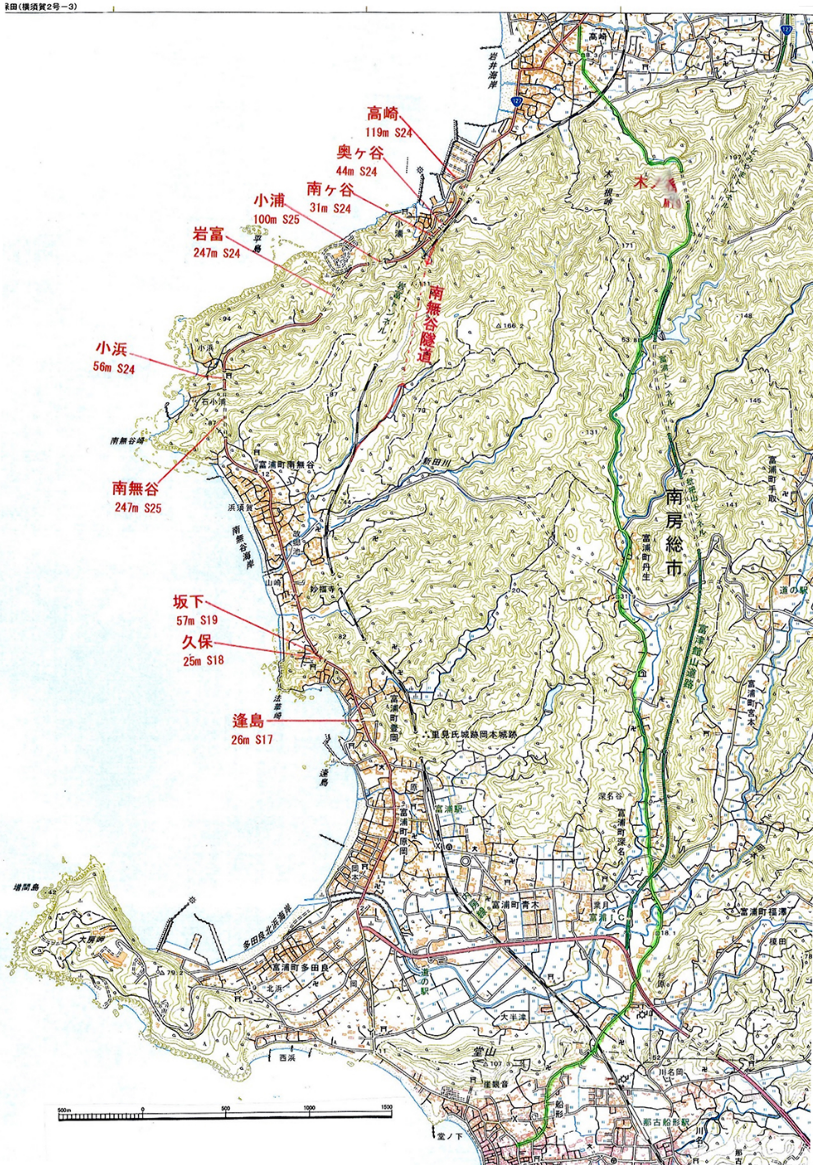
図5 房総西街道（国道127号）と国鉄北條線の隧道の変遷（南房総市高崎～船形間） 1/25,000地形図「那古」図幅（令和4年（2022）調製）に追記 （緑線は明治19年（1886）～明治30年（1897）の県道）
