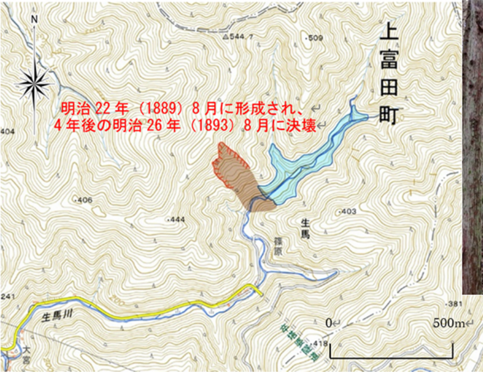
図2 富田川左支・篠原谷の崩壊地と天然ダム (国土交通省近畿地方整備局大規模土砂災害対策技術センター, 2021)
