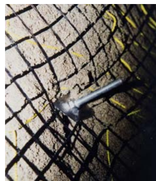
パワーネット工法の模型実験 初期導入力による地面の支圧
