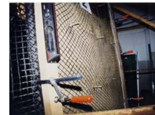
高強度ネット工法の模型実験 ネイル頭部の状況
