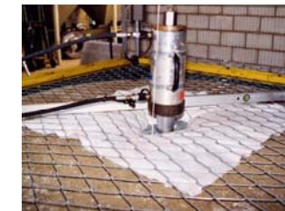
スパイクプレートによる パワーネット工法の要素試験
